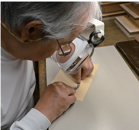
図8 厚さ0.3mmの革の周囲1mmを斜めに削ぐ
